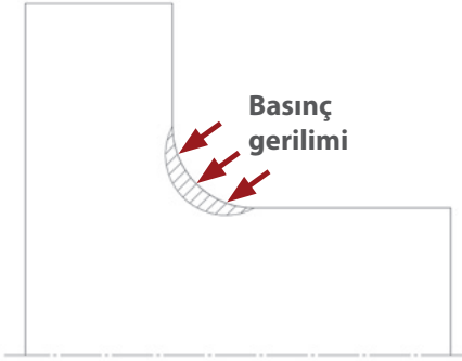
Şekil 5 – Derin ezme sonrası oluşan basınç gerilimi
